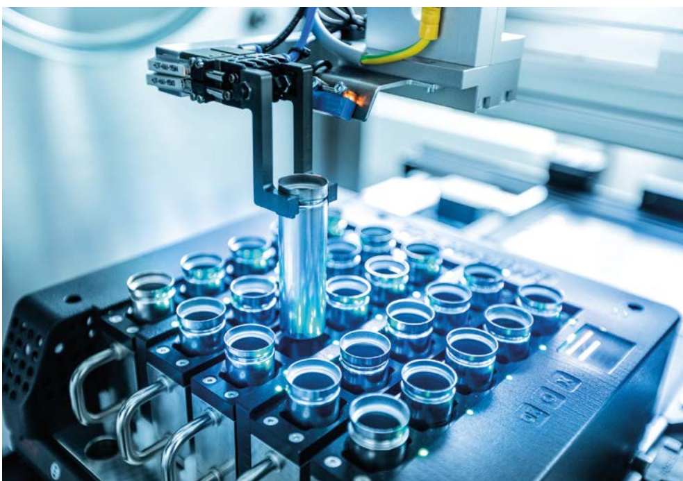
Assemblierung von Batteriezellen mit einem intelligenten Werkstückträger für die digitalisierte Produktion.
