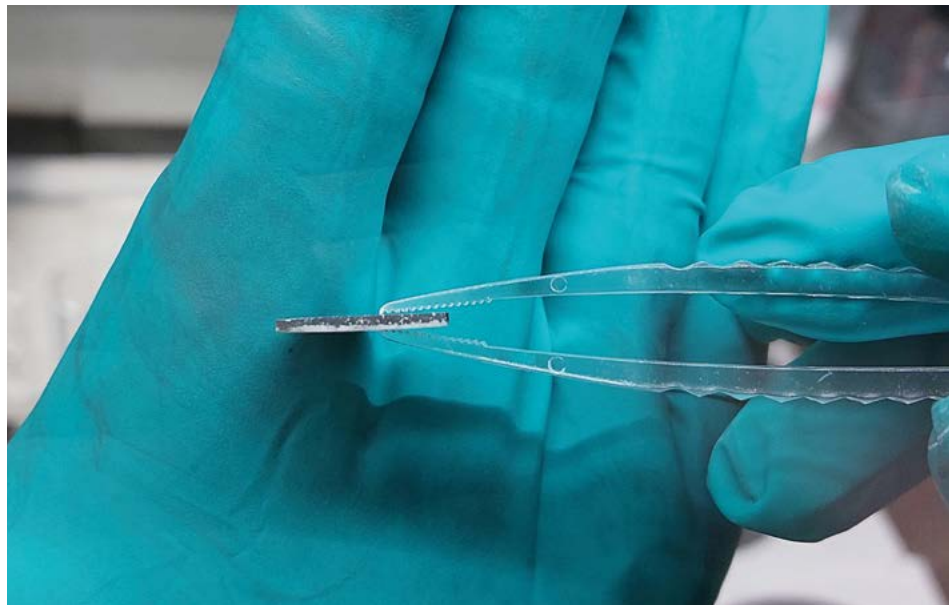
Mehrschichtige, keramische Festkörperkathode für erste Funktionstests.
